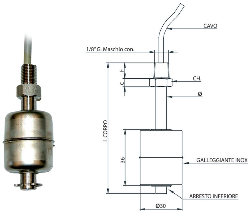
**UTILIZZO:** Costruiti interamente in Inox AISI 316, sono adatti nei processi produttivi di industrie chimiche, farmaceutiche ed alimentari. Adatti per solventi, diluenti e tutti i liquidi compatibili con l'Inox AISI 316.
