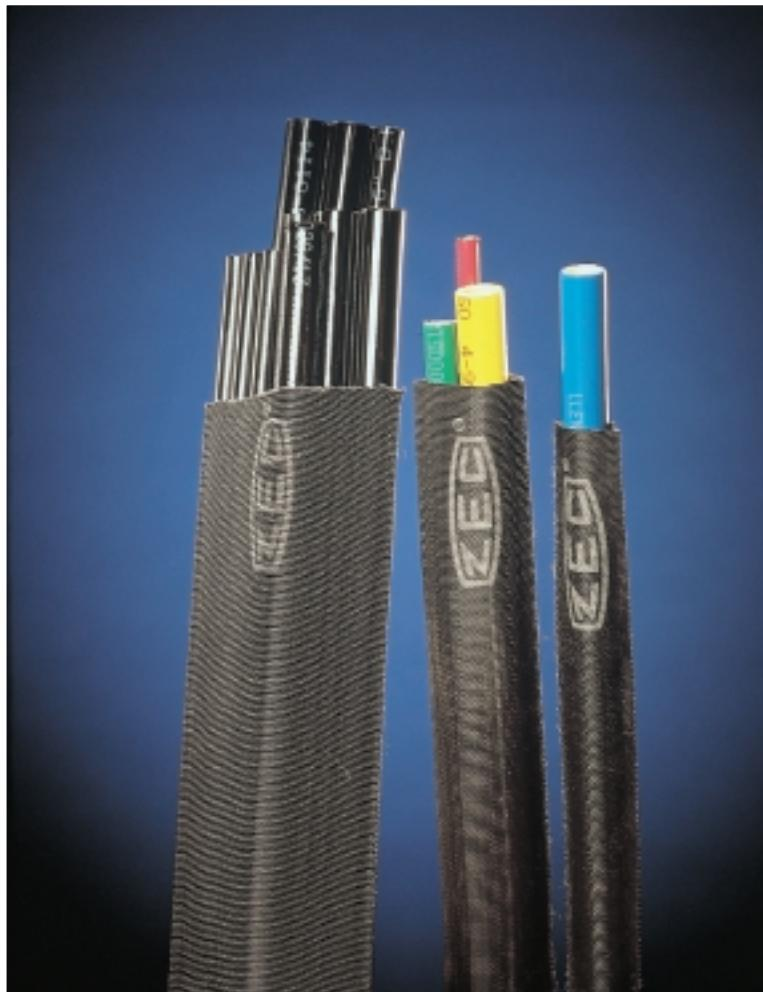
Questa guaina è realizzata in poliestere ad alta tenacità ed è particolarmente indicata per il settore oleodinamico e pneumatico per il contenimento di tubi singoli o multipli. Grazie all'elevata tenacità della materia prima impiegata, ottima è la resistenza alle sollecitazioni meccaniche, così come la compatibilità con oli e prodotti organici.
