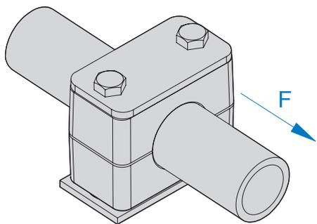
La coppia di serraggio delle viti e i carichi assiali di fissaggio del tubo riportate in tabella sono riferite al montaggio con piastre superiori e viti a testa esagonale secondo la norma EN ISO 4014/4017.
